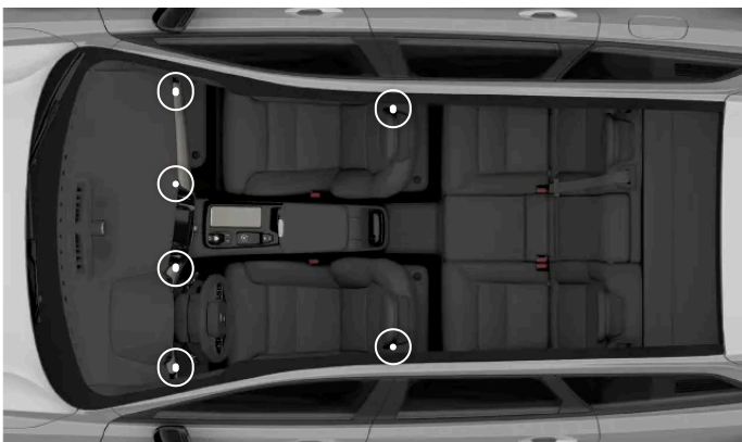
De justerbare luftdysers placering
