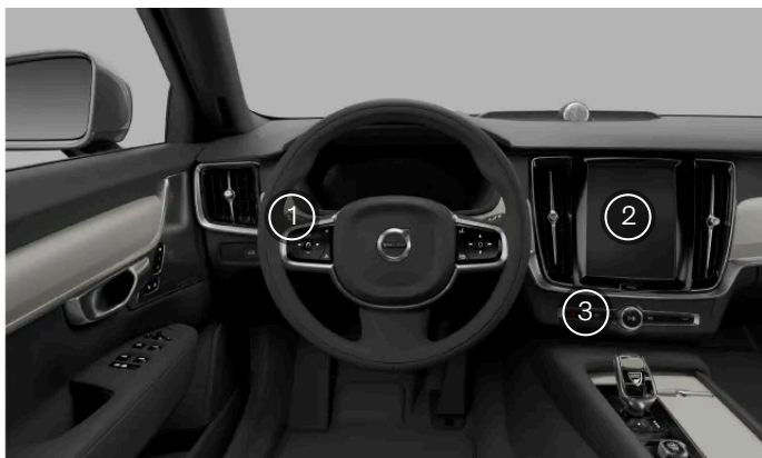
Placering af betjeningslementer til udvendig belysning
