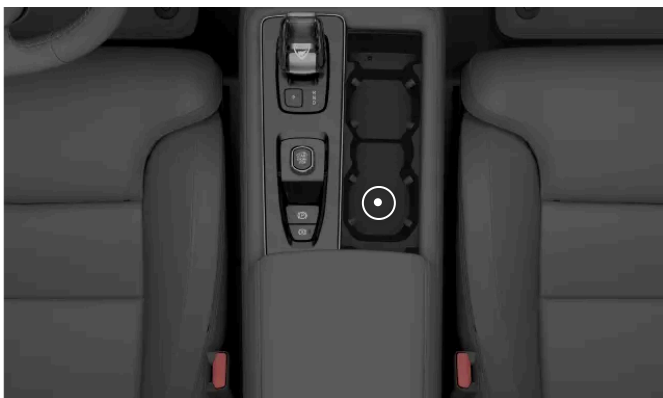
Placering af backup-læseren i tunnelkonsollens kopholder
