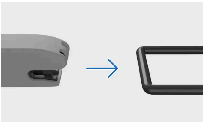
Fastgørelse til ISOFIX-forankringspunkt
