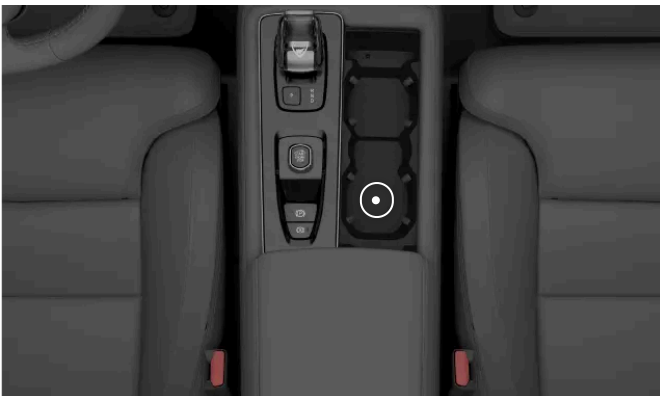
Placering af backup-læseren i tunnelkonsollens kopholder
