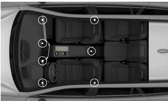
De justerbare luftdysers placering
