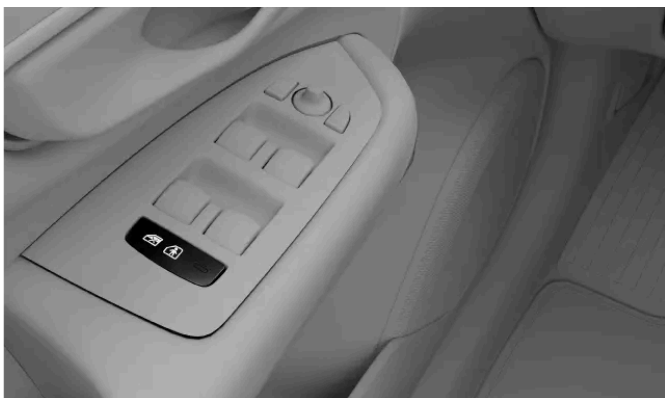
Placering af børnesikringsknappen i dørpanelet
