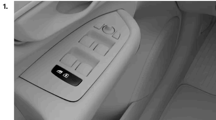
Placering af børnesikringsknappen i dørpanelet
