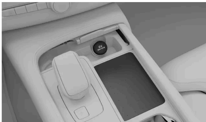
12 V-udtaget i tunnelkonsollen
