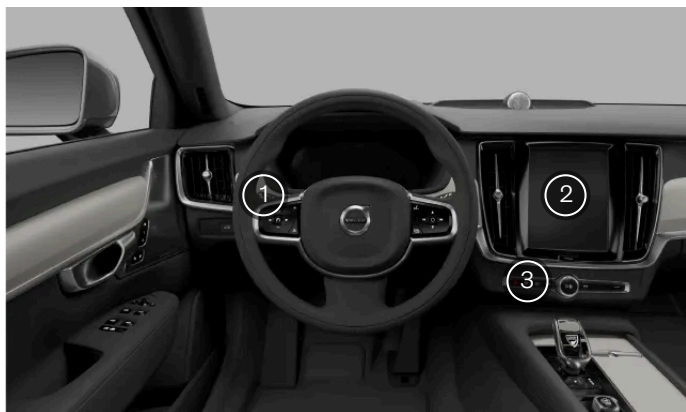
Placering af betjeningslementer til udvendig belysning
