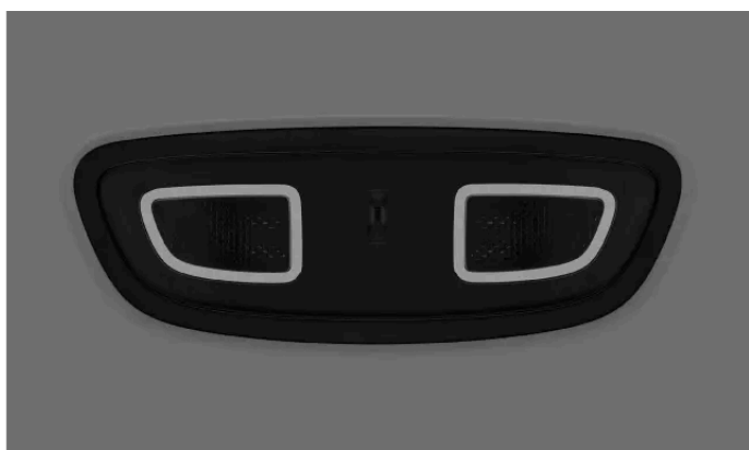
Læselamperne ved bagsædet
