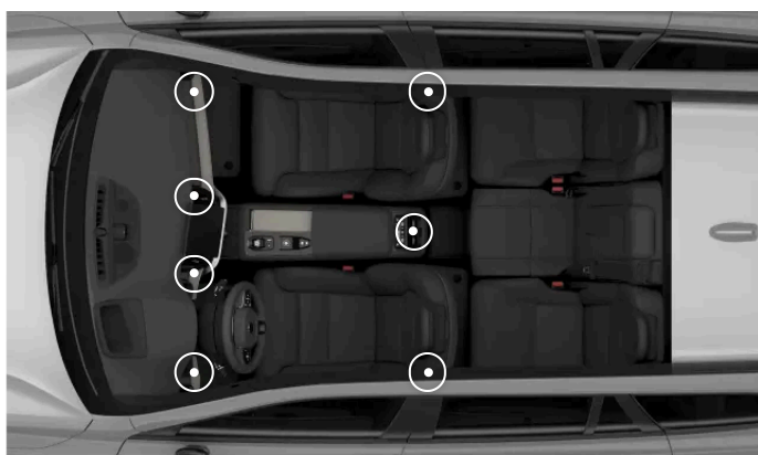
De justerbare luftdysers placering
