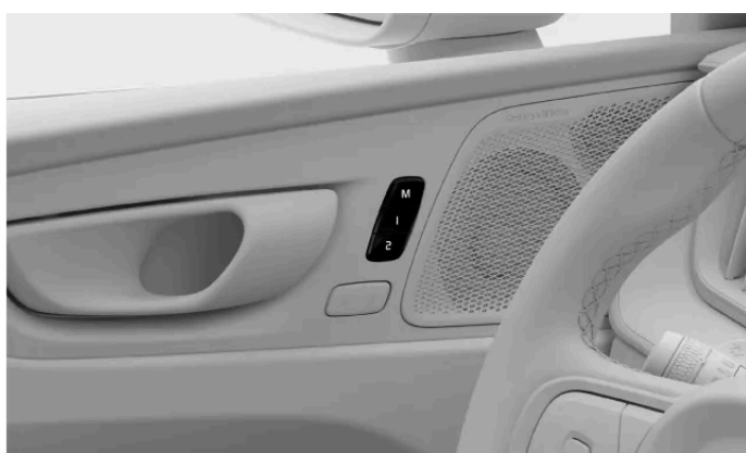
Placering af knapperne til forudindstillinger af sædet
