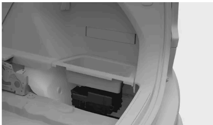
Placering af sikringsskab
