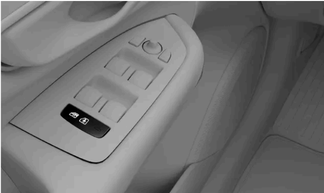
Placering af børnesikringsknappen i dørpanelet
