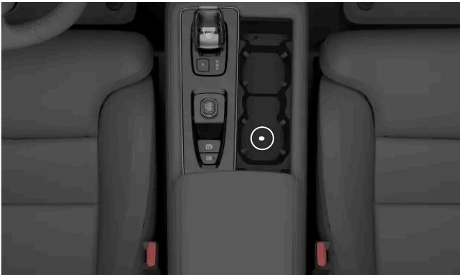
Placering af backup-læseren i tunnelkonsollens kopholder
