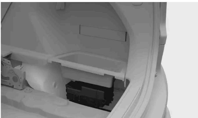
Placering af sikringsskab
