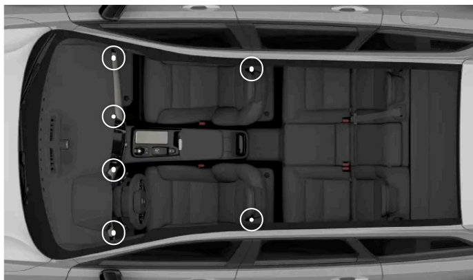
De justerbare luftdyseres placering
