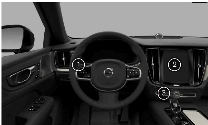
Placering af betjeningslementer til udvendig belysning
