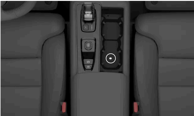
Placering af backup-læseren i tunnelkonsollens kopholder
