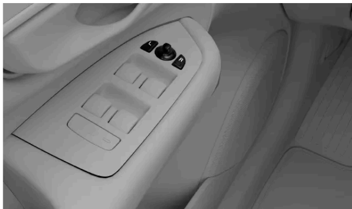
Betjeningselementer til justering af sidespejlene
