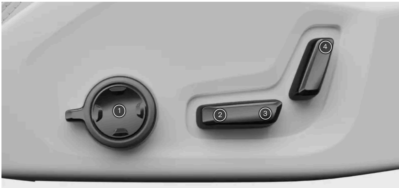
Betjeningselementer på siden af sædet
