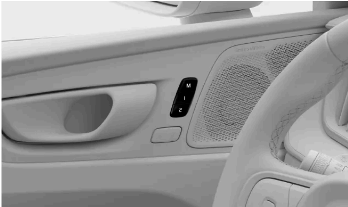
Placering af knapperne til forudindstillinger af sædet
