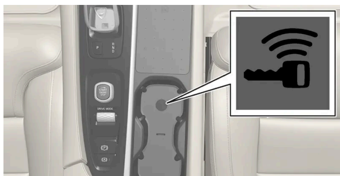
Backup-læserens placering i tunnelkonsollen.
