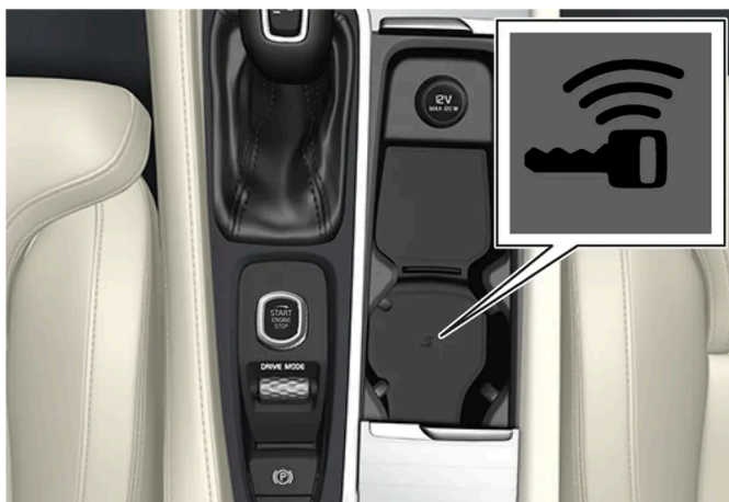
Backup-læserens placering i tunnelkonsollen.
