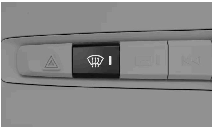
Knappen til maks afrimning på knappepanelet under midterdisplayet
