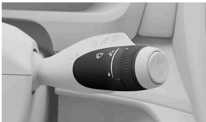
Betjeningselementerne til forrudevviskerne sidder på højre ratarm.
