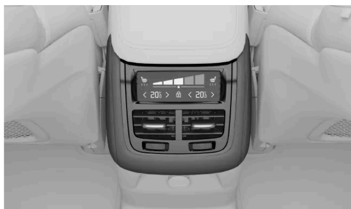
Betjeningslementer til klimaanlægget i tunnelkonsollen
