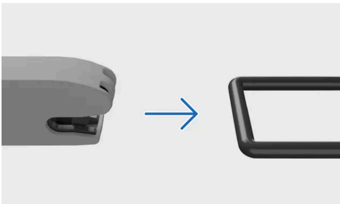
Fastgørelse til ISOFIX-forankringspunkt
