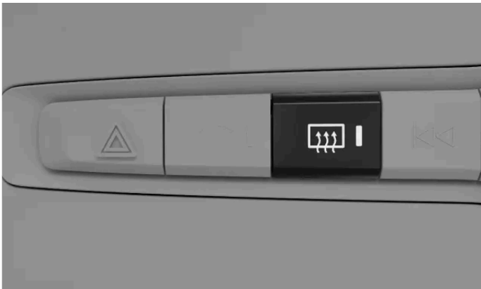
Afrimningsknappen på knappanelet under midterdisplayet
