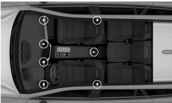
De justerbare luftdysers placering
