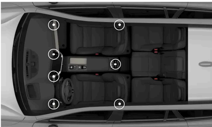
De justerbare luftdysers placering
