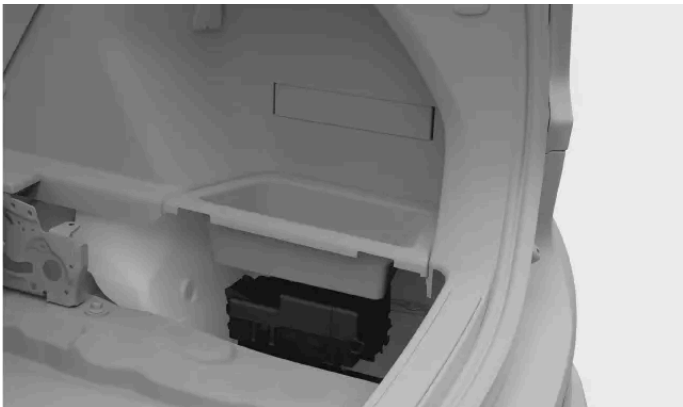
Placering af sikringsskab
