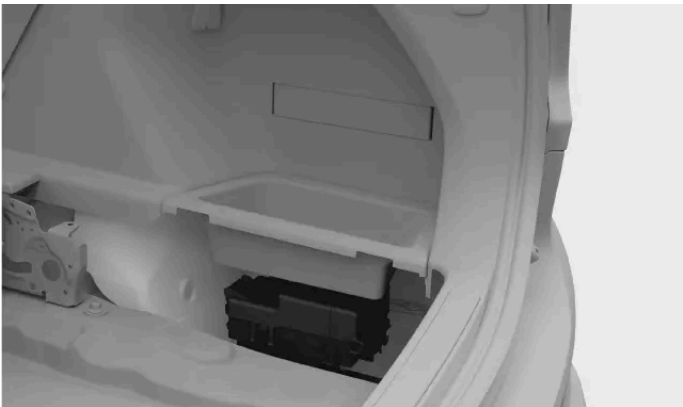
Placering af sikringsskab
