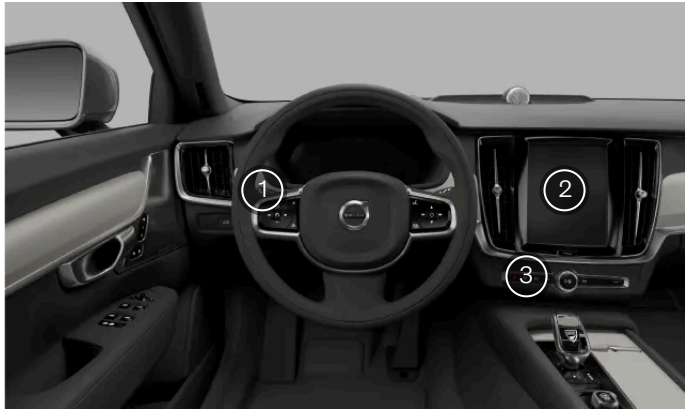
Placering af betjeningsselementer til udvendig belysning
