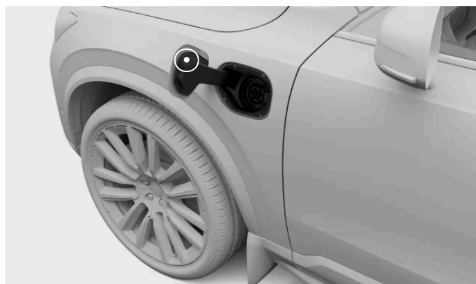
Identifikationsmærkaten sidder på indersiden af opladningslåget.
