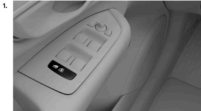
Placering af børnesikringsknappen i dørpanelet
