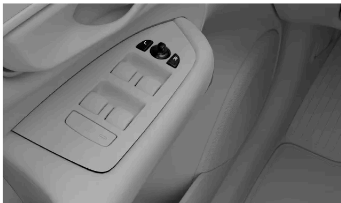
Betjeningselementer til justering af sidespejlene
