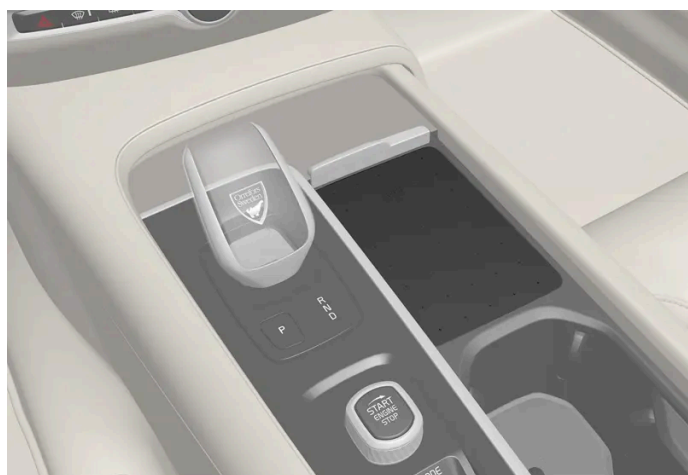
Trådløs telefonlader i tunnelkonsollen.
