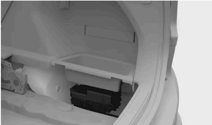
Placering af sikringsskab
