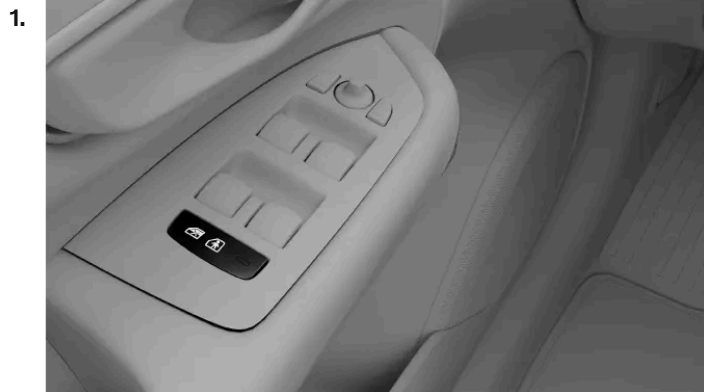
Placering af børnesikringsknappen i dørpanelet
