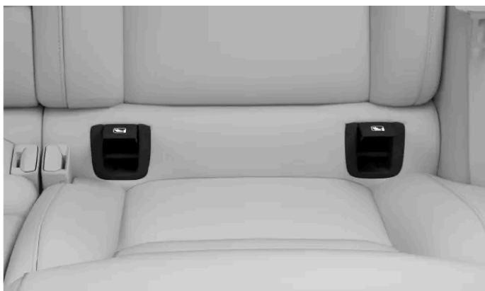
Placeringer af ISOFIX-forankringspunkter til de yderste bagsæder
