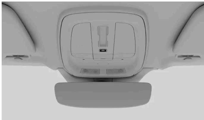
Knappen til slukning af automatisk lys i loftskonsollen
