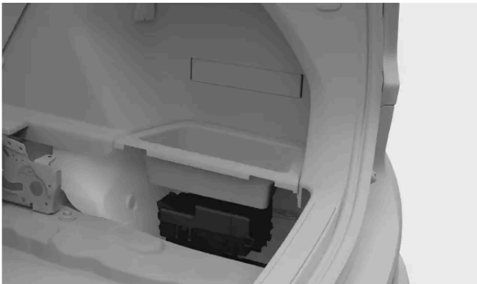
Placering af sikringsskab
