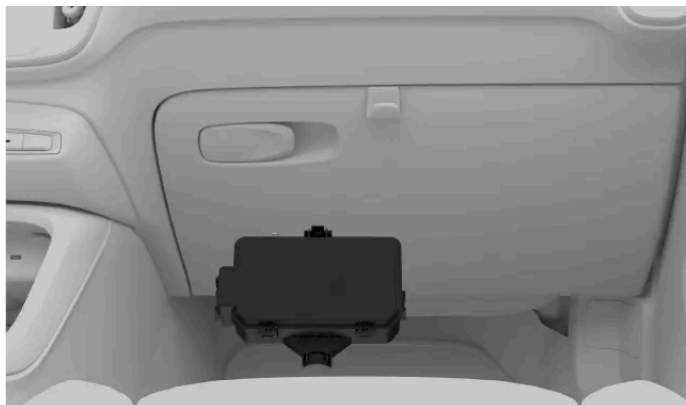
Placering af sikringskab
