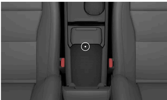
Placering af backup-læseren i tunnelkonsollens opbevaringsrum
