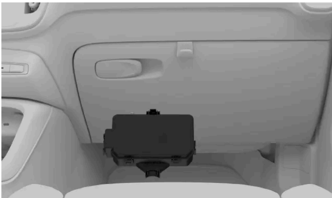
Placering af sikringsskab
