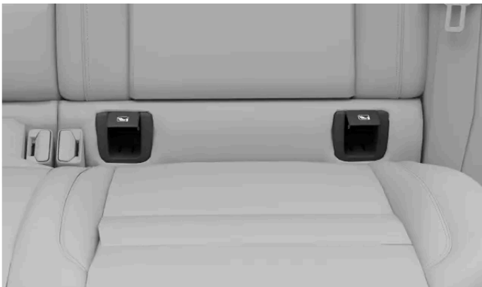
Placeringer af ISOFIX-forankringspunkter til de yderste bagsæder
