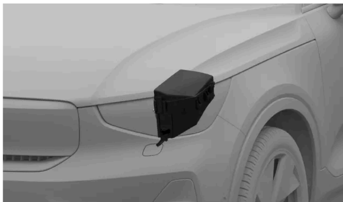
Placering af sikringskab
