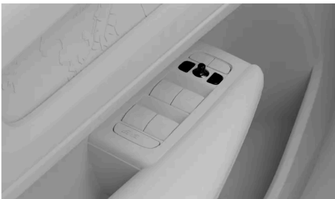
Betjeningslementer til justering af sidespejlene
