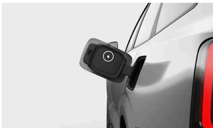
Identifikationsmærkaten sidder på indersiden af opladningslåget.
