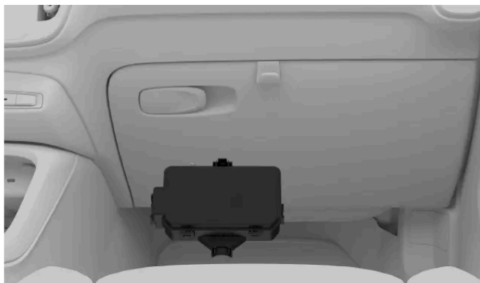
Placering af sikringskab
