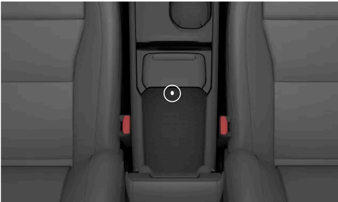
Placering af backup-læseren i tunnelkonsollens opbevaringsrum
