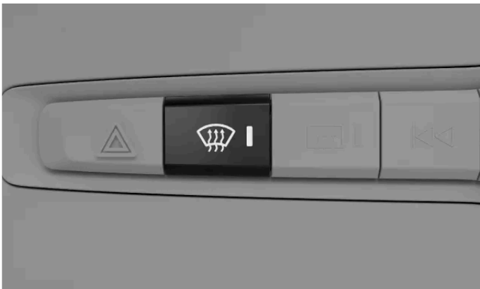
Knappen til maks afrimning på knappanelet under midterdisplayet
