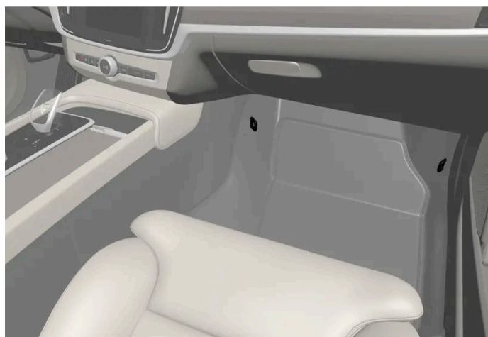
Befæstelsespunkternes placering på forsædet.
