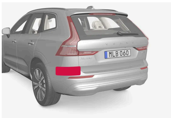
Placering af bageste radarenheder
