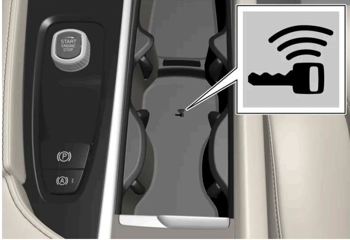
Backup-læserens placering i tunnelkonsollen.
