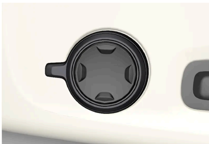
Multifunktionsknappen, placeret på siden af sædets sidedel.
