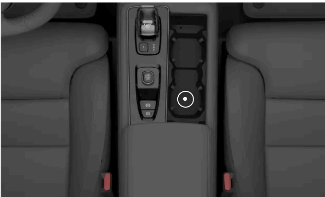
Placering af backup-læseren i tunnelkonsollens kopholder
