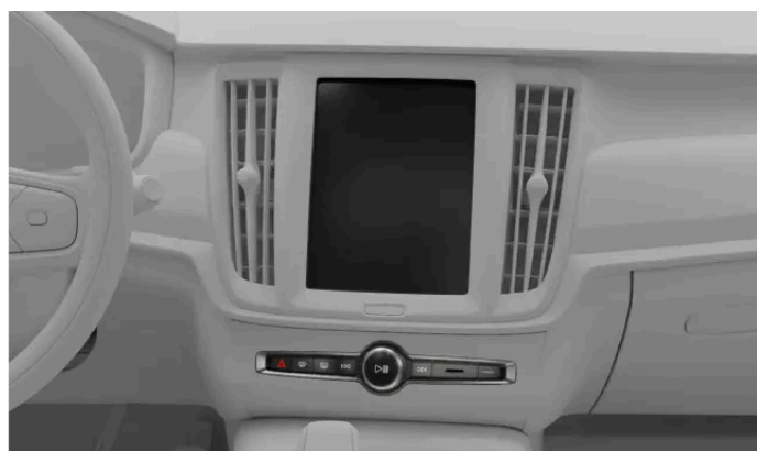
Midterdisplay og afrimningsknapper på knappepanelet under midterdisplayet
