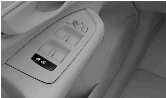
Placering af børnesikringsknappen i dørpanelet
