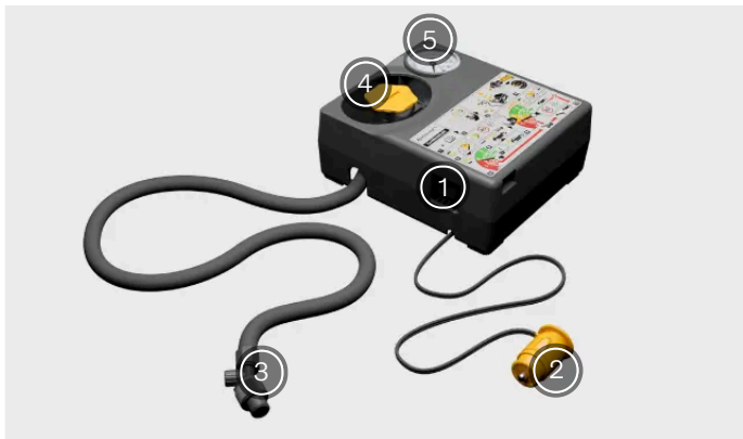
Oversigt over dæklappesættets kompressor
