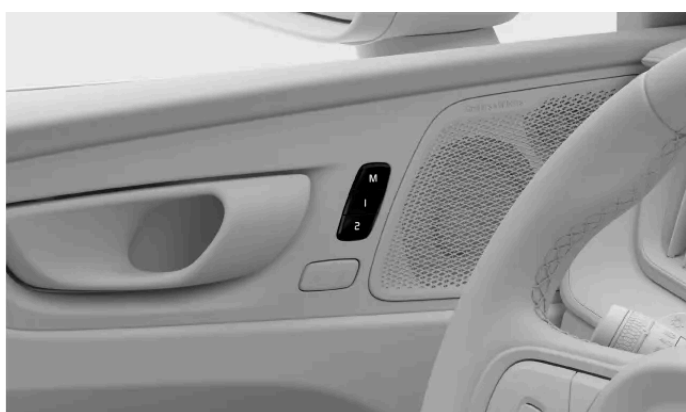
Placering af knapperne til forudindstillinger af sædet
