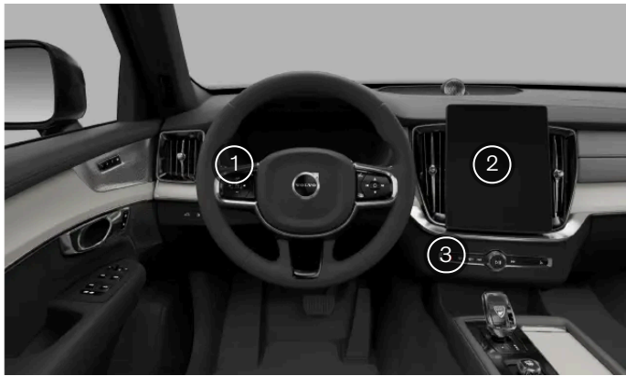
Placering af betjeningslementer til udvendig belysning
