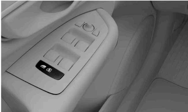
Placering af børnesikringsknappen i dørpanelet
