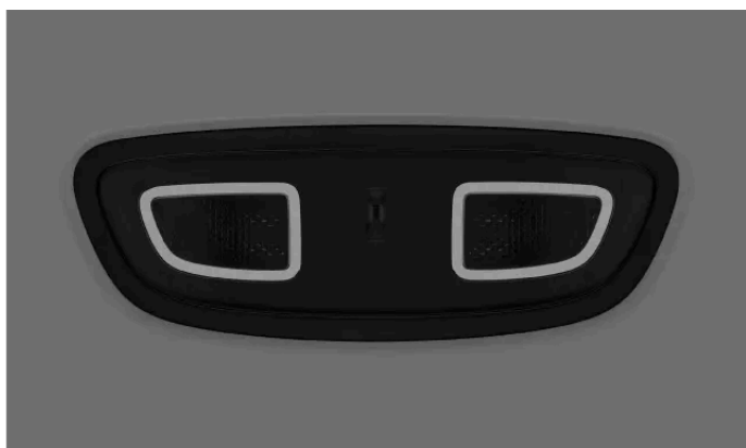
Læselamperne ved bagsædet
