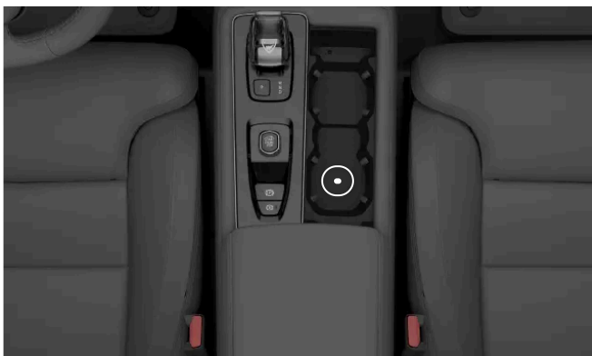
Placering af backup-læseren i tunnelkonsollens kopholder
