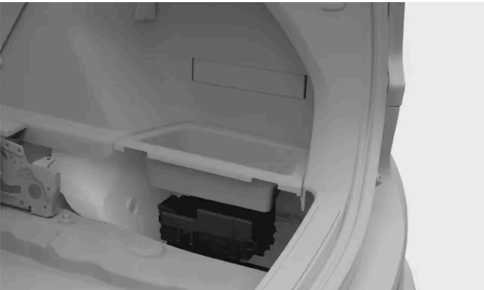
Placering af sikringsskab
