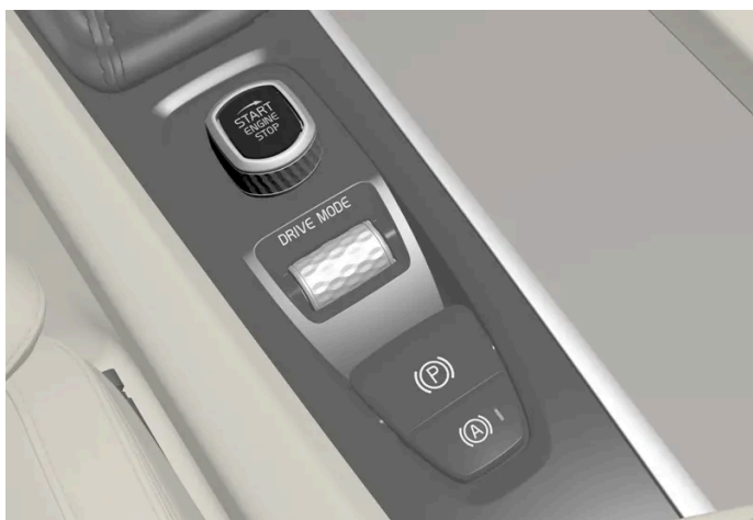
Startknappen i tunnelkonsollen.
