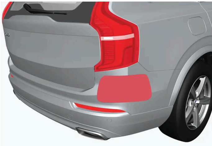
Placering af bageste radarenheder
