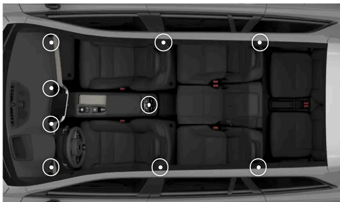
De justerbare luftdyseres placering
