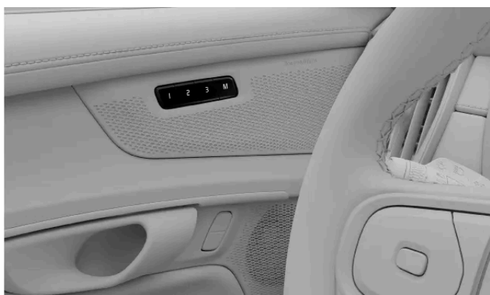
Placering af knapperne til forudindstillinger af sædet
