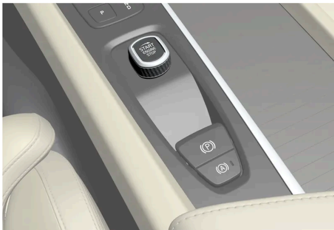
Startknappen i tunnelkonsollen.
