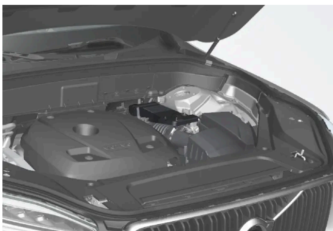
Støttebatteri på 12 V er placeret i motorrummet.
