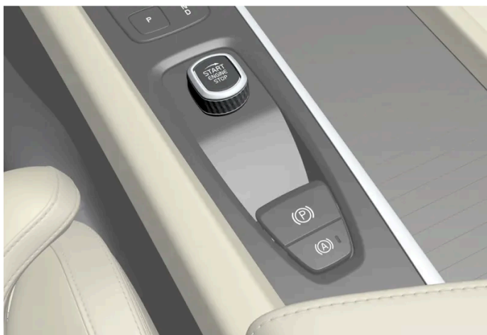
Startknappen i tunnelkonsollen.
