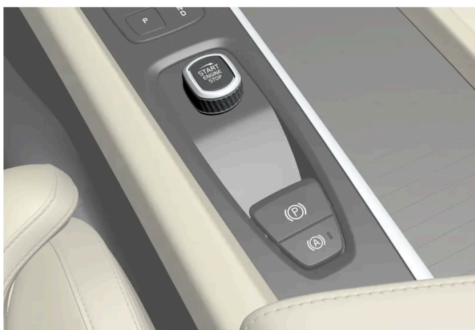
Startknappen i tunnelkonsollen.
