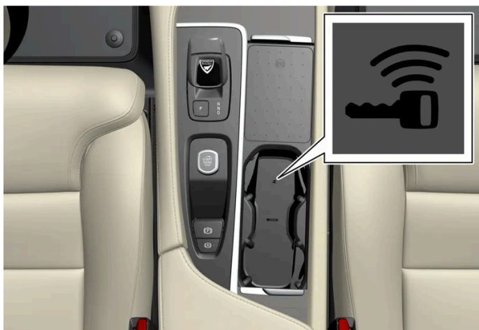
Backup-læserens placering i tunnelkonsollen.
