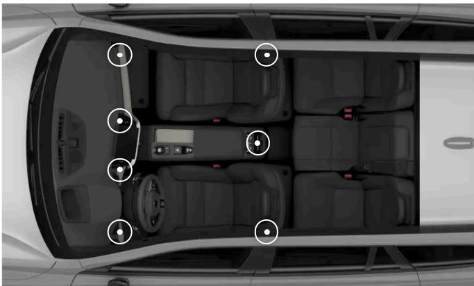
De justerbare luftdysers placering
