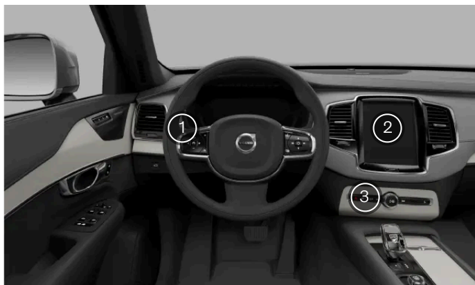
Placering af betjeningslementer til udvendig belysning
