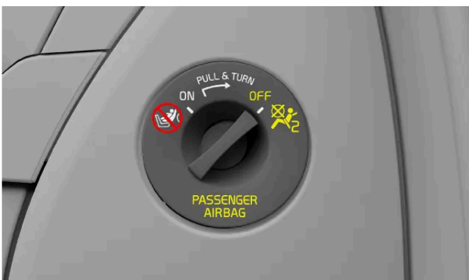
Airbags desactivados. Utilice siempre esta posición cuando haya un sistema de retención infantil montado a contramarcha en el asiento del acompañante delantero.
