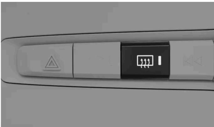
Botón del desempañador trasero en el panel de botones de debajo de la pantalla central
