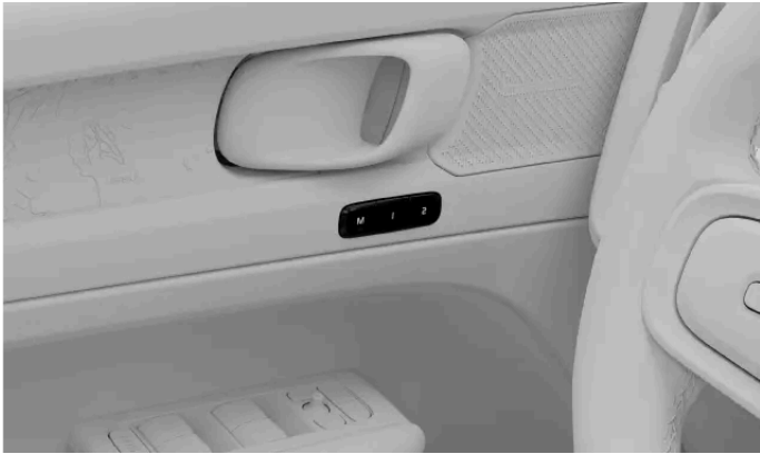
Ubicación de los botones de ajuste de asiento predefinido
