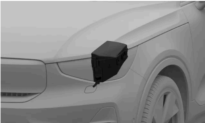
Ubicación de la caja de fusibles
