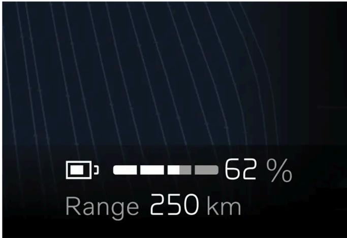
De fábrica la autonomía del automóvil se basa en el valor certificado. Cuando el automóvil se conduce durante un cierto periodo, la autonomía se basa en el historial de los patrones de conducción.
