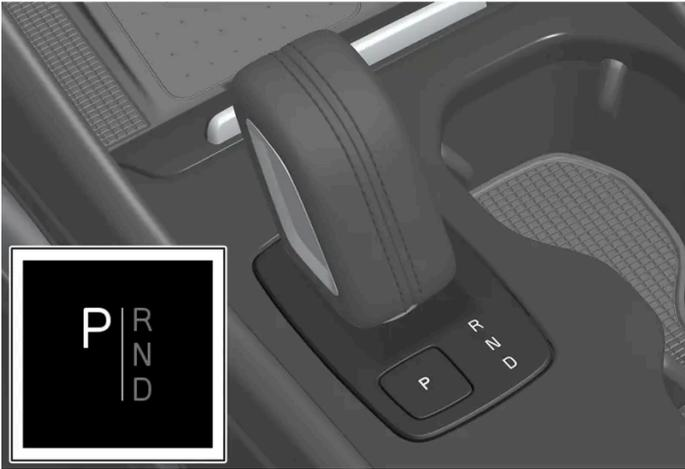
La pantalla del conductor muestra la posición de cambio que se utiliza en ese momento.
