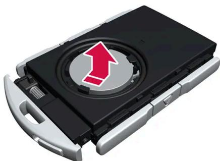
El lado (+) de la pila está hacia arriba. Suelte la pila presionando junto a su borde y levantándola a continuación.
