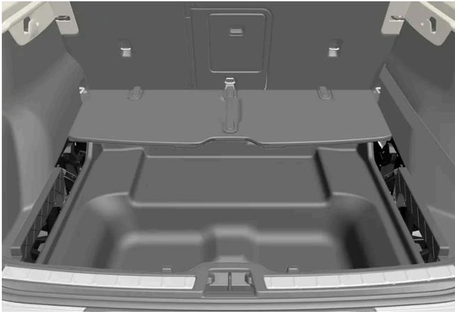
Repliegue el piso de carga plegable hacia delante.
