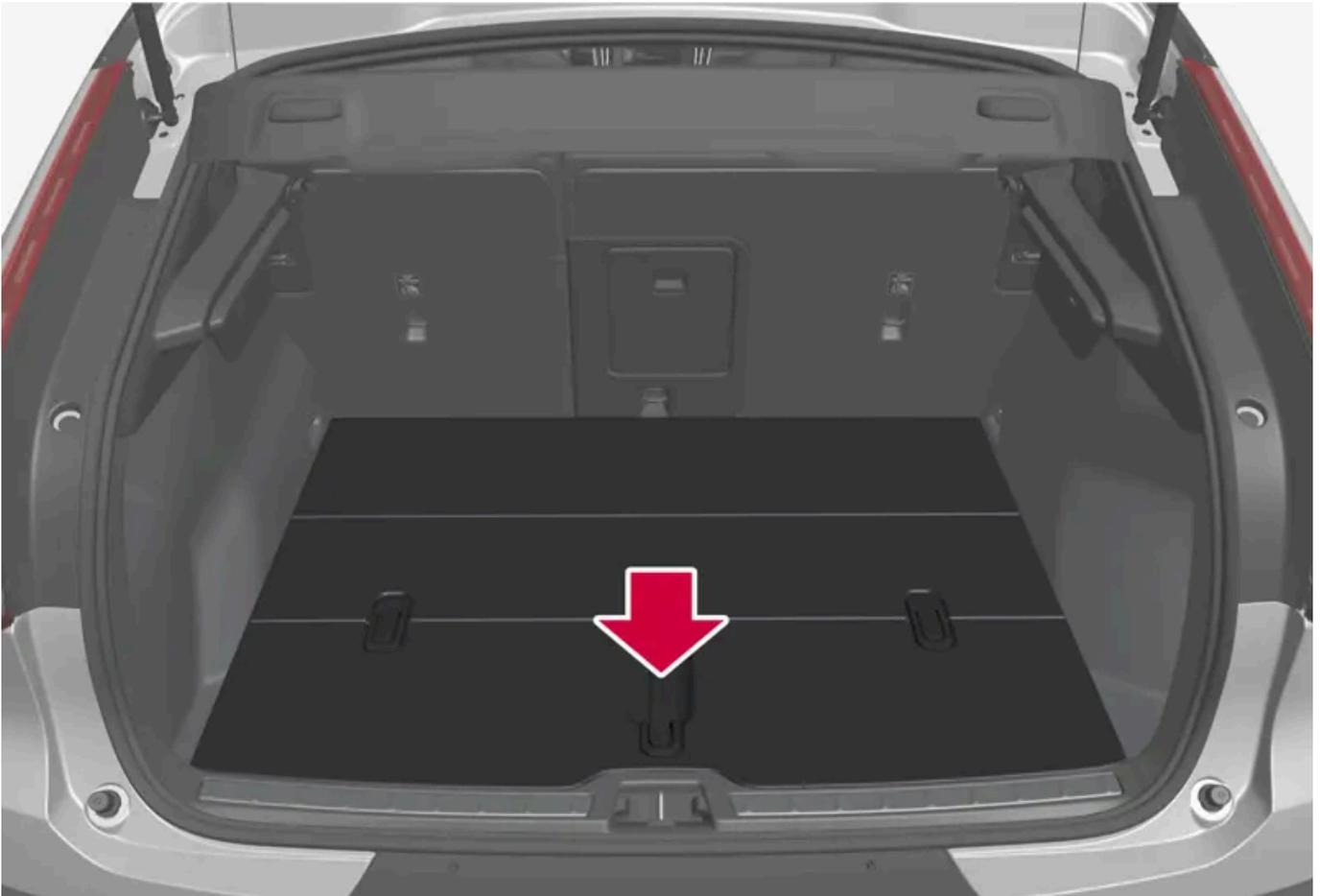
Compartimento de carga con compartimento guardaobjetos bajo el piso de carga.
