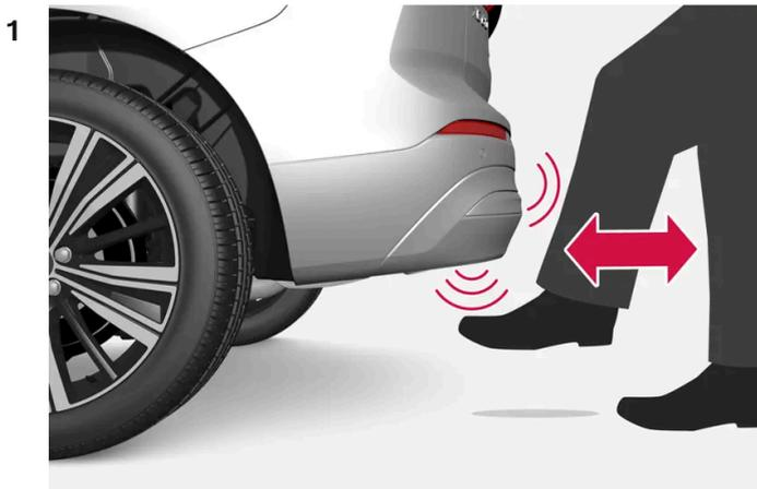
Realice **un** movimiento hacia adelante con el pie dentro de la zona del sensor, bajo el parachoques trasero. A continuación, retroceda un paso. No se debe tocar el parachoques.
