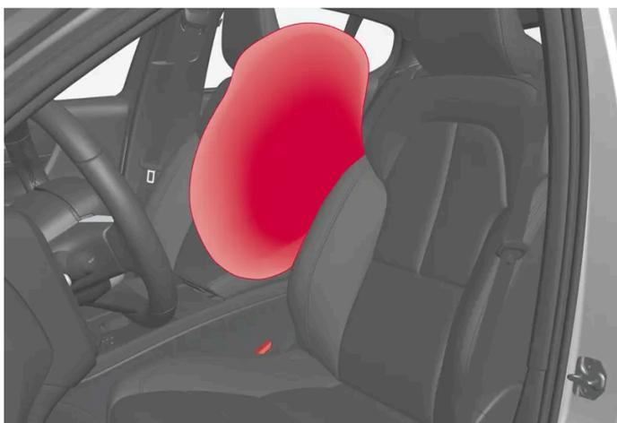
Los airbags laterales interiores van montados en las estructuras interiores de los asientos delanteros y ofrecen protección al conductor y el acompañante. El asiento lleva estampadas las letras AIRBAG.
