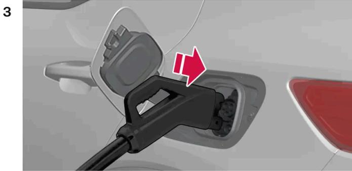
Sujete el cable de carga con ambas manos y haciendo presión introduzca completamente el cable en la toma de carga del automóvil. Mantenga hacia arriba el terminal de carga unos segundos. El cable de carga queda automáticamente inmovilizado en la toma de carga al cabo de un par de segundos. Asegúrese de que el cable de carga quede bien inmovilizado para que la carga pueda empezar.
