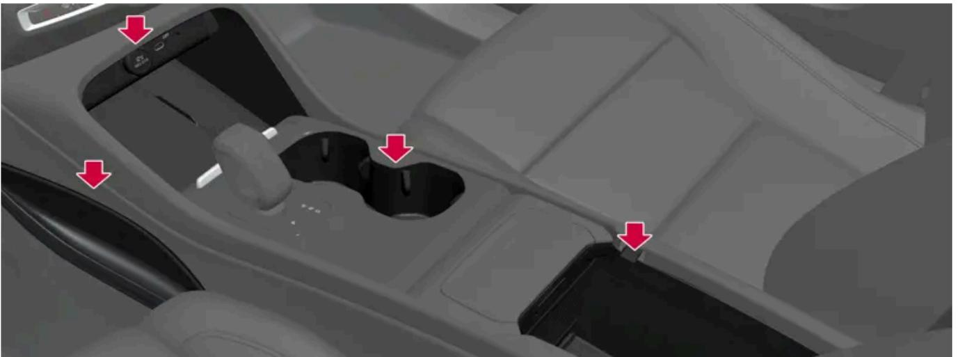
Compartimento junto al espacio para las piernas, la toma eléctrica y los puertos USB sobre el cargador de teléfono inalámbrico\*, portavasos y compartimento bajo el apoyabrazos en la consola central.
