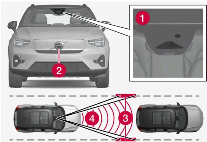
Las unidades de cámara y radar miden la distancia con respecto al vehículo que circula delante y detecta las señalizaciones laterales.
