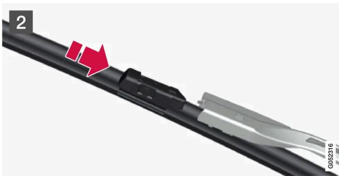
Compruebe que los limpiaparabrisas se encuentren en modo de servicio y suba los brazos de estos. El modo revisión se activa y desactiva a través de la pantalla central cuando el automóvil está detenido y no se accionan los limpiaparabrisas.
