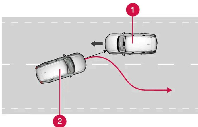
La función puede asistir reconduciendo el vehículo dentro del propio carril.
