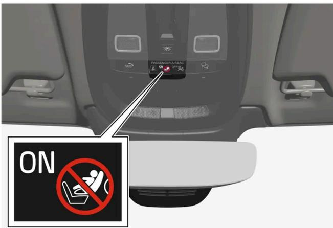
➤ En la consola del techo aparece un mensaje y un símbolo de advertencia indicando que el airbag del asiento del acompañante está conectado.
