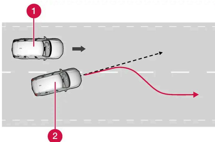
La función puede asistir reconduciendo el vehículo dentro del propio carril.
