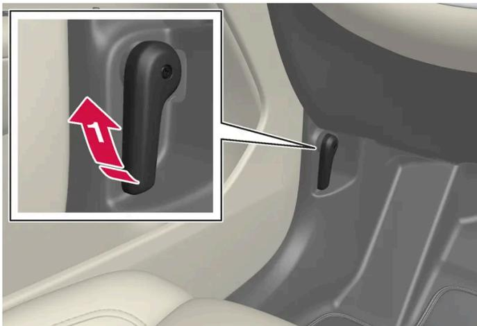
➔ Tire de la palanca situada al lado de los pedales para liberar el capó de su posición de bloqueo.
