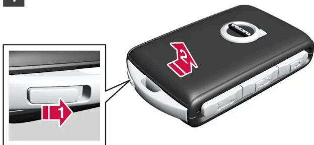
Desplace a un lado el fiador de la fijación de llavero y saque la carcasa delantera hacia afuera del soporte deslizándola.
