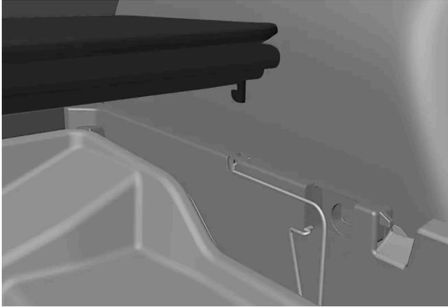
El piso de carga puede volver a colocarse con cuidado sobre los muelles de enganche, pero sin fijarlo.
