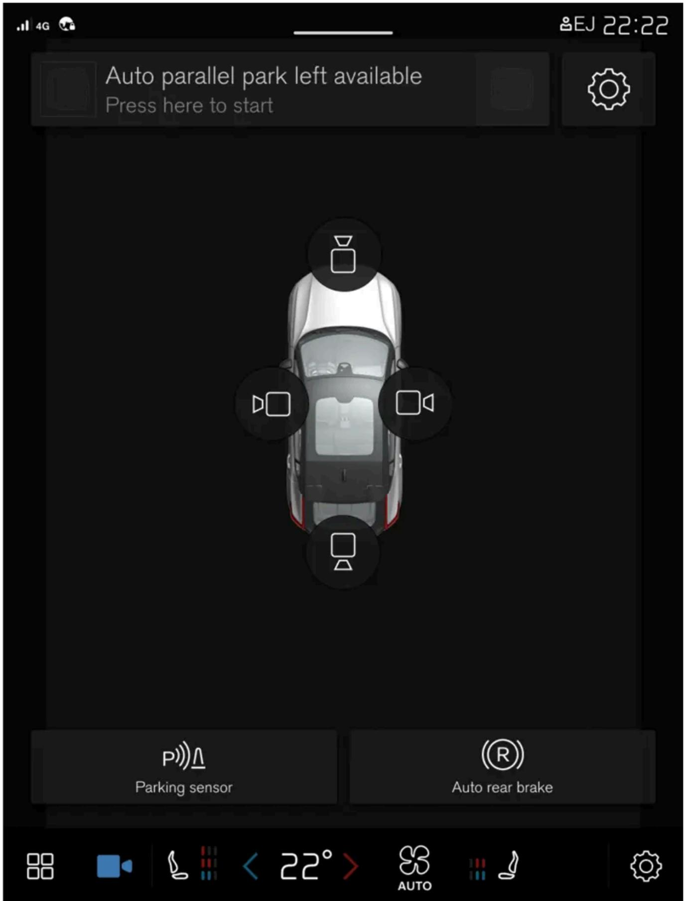
La vista de cámara muestra las cámaras del aparcamiento asistido (PAC<sup>[1]</sup>) donde aparece una vista combinada de 360° y una vista independiente de cada una de las cuatro cámaras: trasera, delantera, izquierda o derecha.
