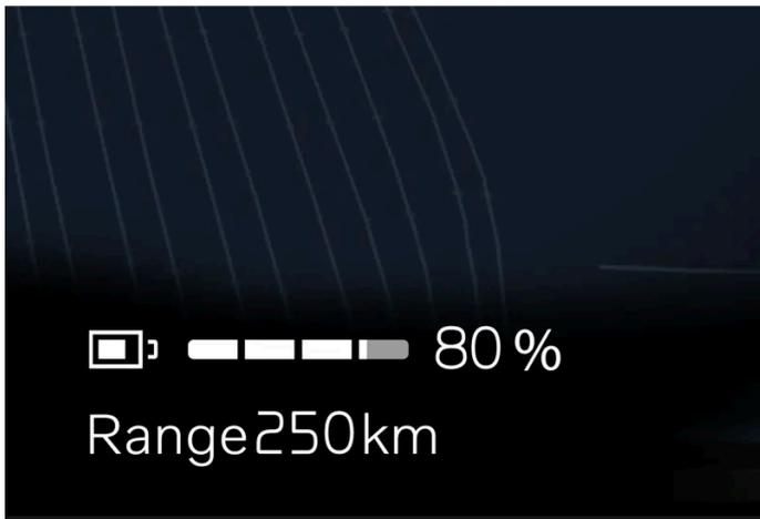
El indicador de batería de la parte inferior de la pantalla del conductor presenta el nivel de carga de la batería de alta tensión. Si es inferior a 50 km (30 millas), la autonomía se mostrará junto al indicador de batería. La autonomía puede verse determinada por diversos factores, como, por ejemplo, el modo de conducción y la temperatura.
