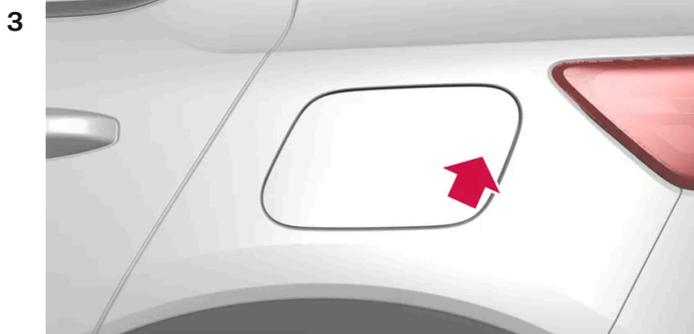
Presione sobre la parte posterior de la tapa de carga para abrirla<sup>[2]</sup>.
