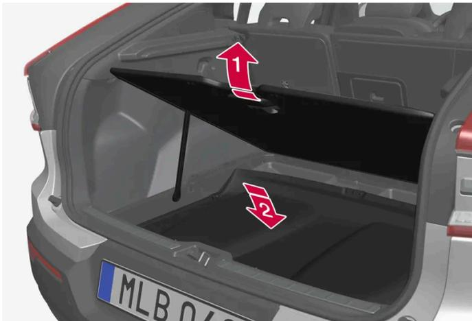
La bandeja trasera desmontada puede guardarse bajo el piso del compartimento de carga.
