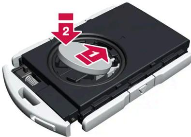
Ponga una pila nueva con el polo (+) hacia arriba. No toque con los dedos los contactos de la pila de la llave.
