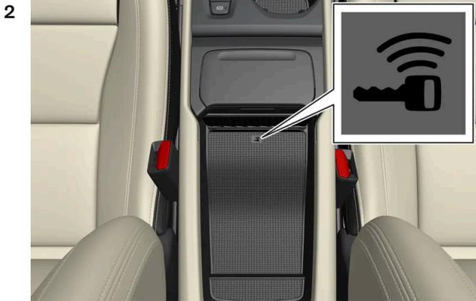
Coloque la llave sobre el símbolo de llave en el lector de copias del compartimento de la consola del túnel.
