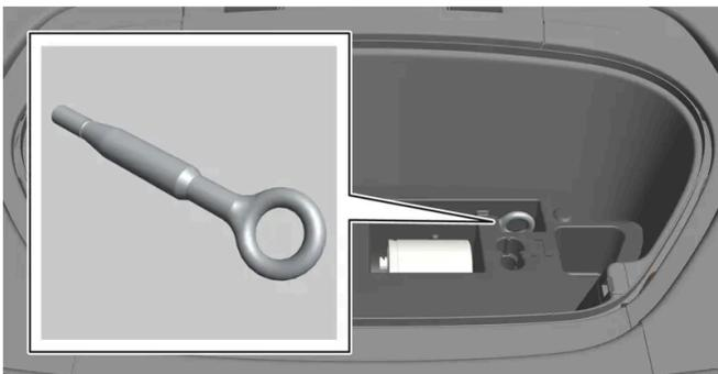
Saque la argolla de remolque situada en el bloque de gomaespuma bajo el capó.
