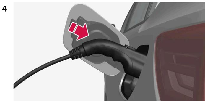
Retire la tapa de protección del mango de carga y encaje este a continuación hasta el fondo del enchufe de carga del vehículo.
