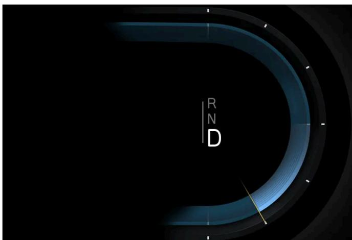
Indicación en la pantalla del conductor en caso de frenado regenerativo.
