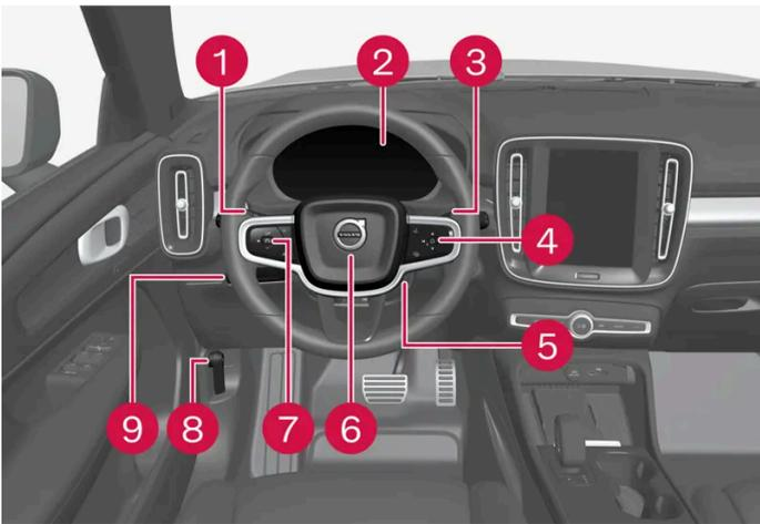
**1** Luces de posición, luces diurnas, luces de cruce, luces largas, intermitentes, luces antiniebla y luces de curva\*, luz antiniebla trasera, puesta a cero de cuentakilómetros parciales
