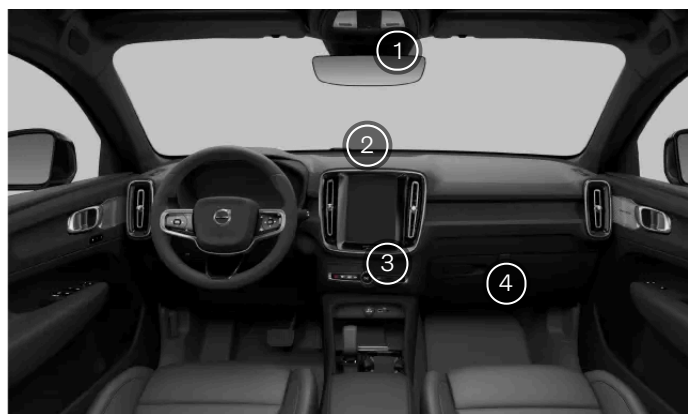
Los sensores de climatización interiores
