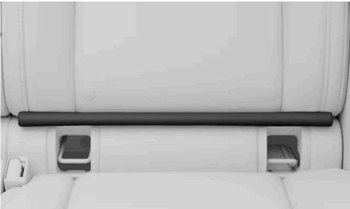
La tapa ISOFIX plegada, colocada en el interior del hueco que está por encima de los puntos de anclaje.
