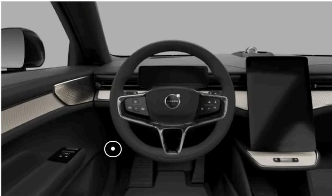
La primera palanca está debajo del salpicadero en el lado del conductor, justo delante de la bisagra de la puerta.
