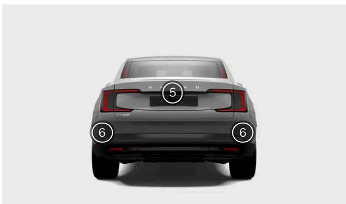
5 Hay una cámara de visión posterior en la parte central trasera del automóvil.
