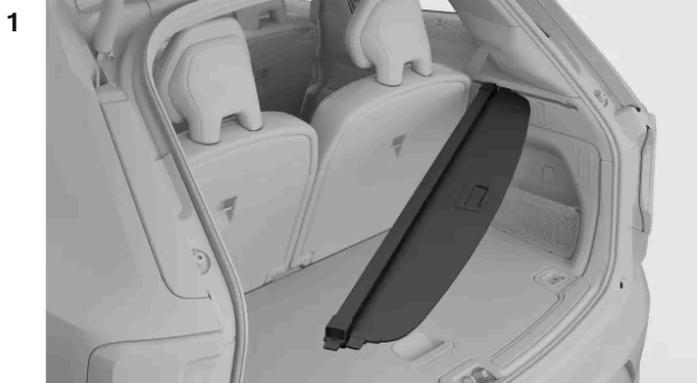
Introduzca un extremo de la cubierta de equipajes en la muesca de la ranura de uno de los laterales del maletero. La muesca puede identificarse por una línea. Asegúrese de que el extremo de la cubierta de equipajes está alineado con la marca.
