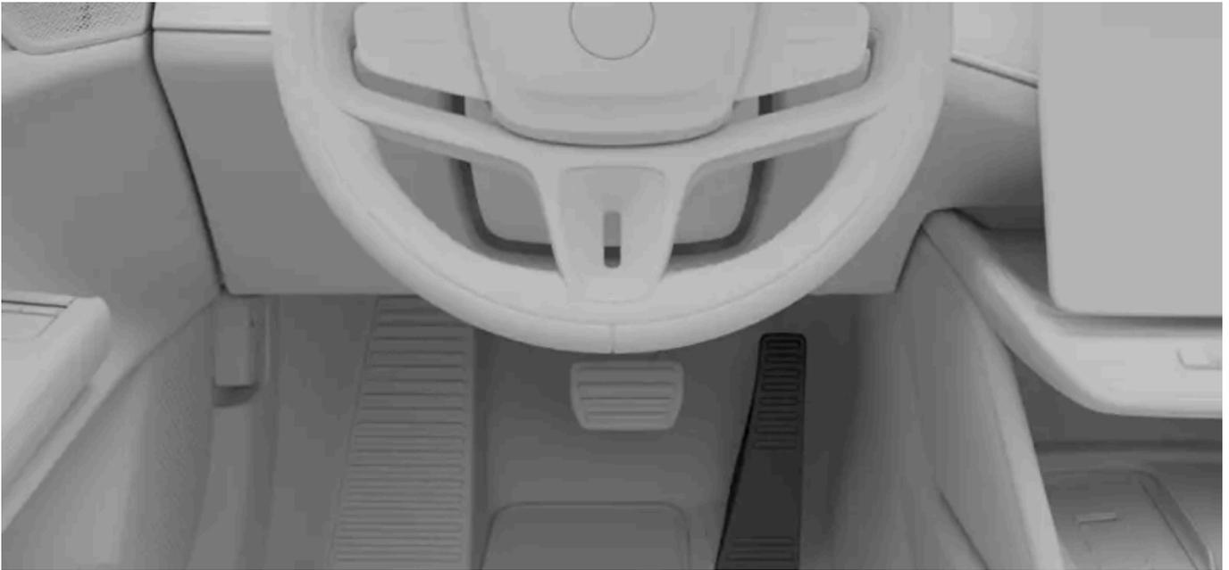
En función del uso del pedal de acelerador el comportamiento de frenado es diferente. Al pisar el acelerador el automóvil acelera con normalidad, pero al soltar el pedal se activa el frenado. Cuanto más suelte el pedal, más intenso es el frenado. Si suelta del todo el acelerador, el automóvil se detendrá por completo.
