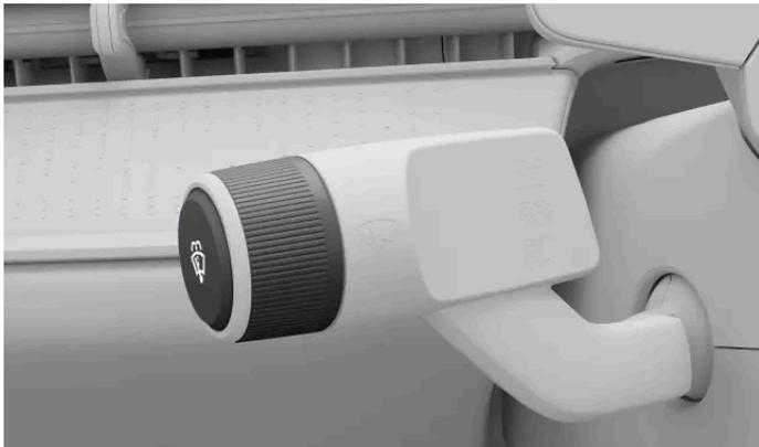
Puede activar diferentes modos del limpiaparabrisas delantero utilizando la palanca izquierda. Los modos son:
