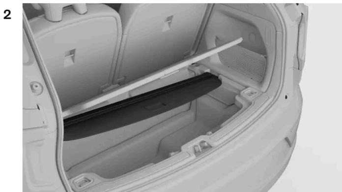
Introduzca el extremo derecho de la cubierta de equipajes en su soporte, situado en la parte derecha del compartimento bajo el maletero.
