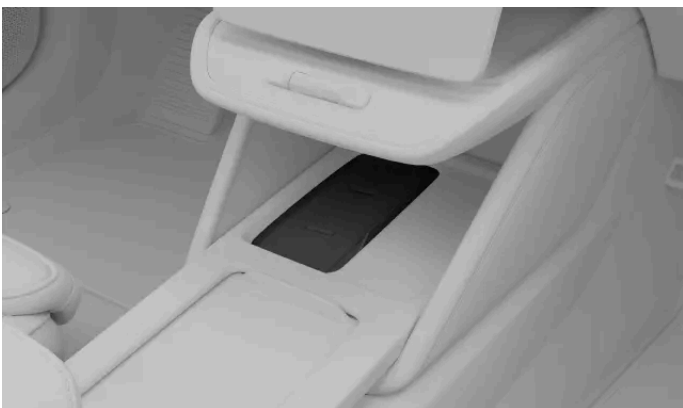
El lector de llaves situado entre los asientos delanteros también es un cargador inalámbrico.
