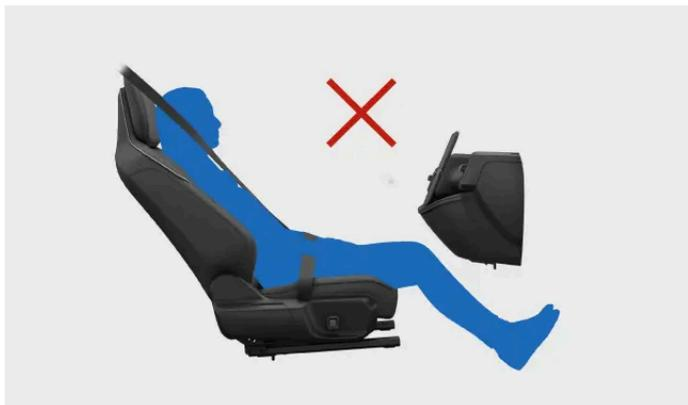
No incline el respaldo a una posición acostada. El cinturón de seguridad debe mantenerse tenso encima del hombro.
