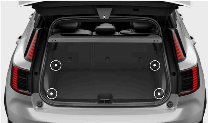
Las argollas de fijación de carga están situadas en las cuatro esquinas del maletero. Puede utilizarlas para fijar correas y asegurar la carga en el maletero.
