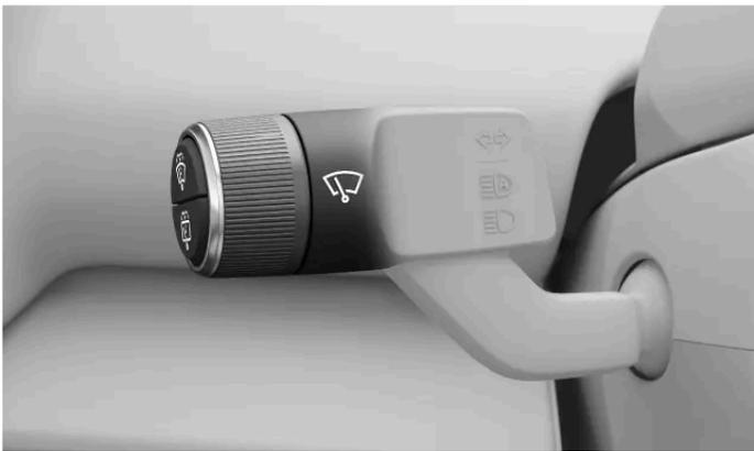
Puede controlar los limpiaparabrisas y los lavaparabrisas utilizando la rueda y los botones de la palanca izquierda del volante.
