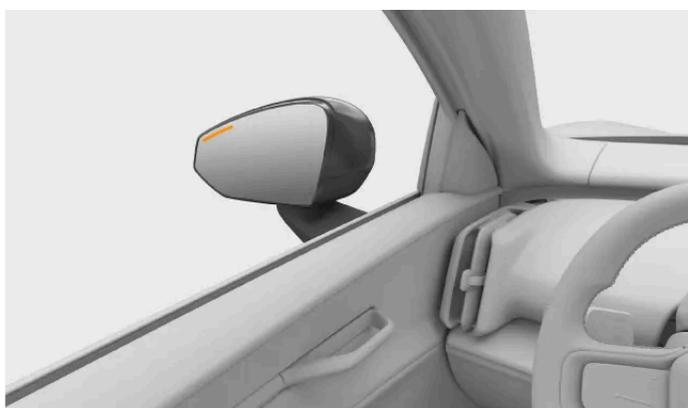
Cuando el automóvil detecta tráfico que se aproxima a los laterales del automóvil, aparece una luz en el retrovisor exterior, junto con una notificación en la pantalla. Si empieza a abrir la puerta en el lado en el que se ha detectado tráfico, la alerta se intensifica. Puede sonar una alerta acústica junto con las alertas visuales, en función de la urgencia de la advertencia.
