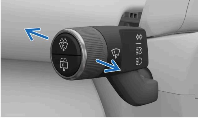
Puede mover la palanca izquierda hacia delante o hacia atrás para cambiar entre las diferentes opciones de luces largas. La palanca siempre vuelve a la posición neutra.
