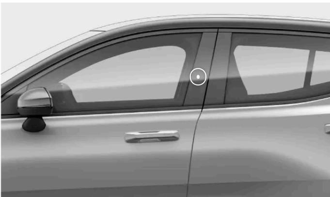
Ubicación del lector de llave en el montante de la puerta del conductor.
