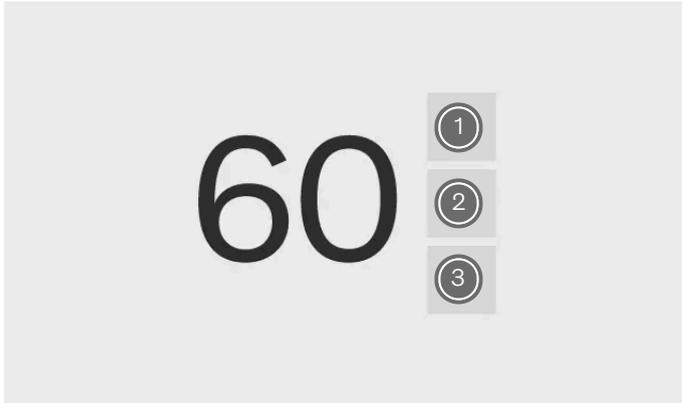
Los símbolos de las señales de tráfico también pueden aparecer en el otro lado del velocímetro, en función del modo de visualización activo en la zona de información del conductor.
