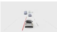
Las intervenciones de la asistencia para el mantenimiento en el carril se indican a través de una línea sólida de color rojo.
