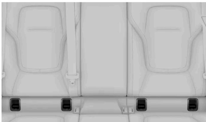
Los puntos de anclaje ISOFIX de los asientos traseros están ubicados detrás de una tapa en la parte inferior del respaldo de los asientos traseros exteriores. Hay que desplegar la tapa para acceder a los puntos de anclaje.
