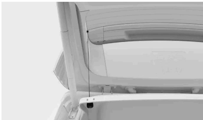
**1** Separe cada cordón de los puntos de sujeción de la compuerta del maletero.
